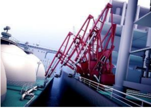
आकृती 7.15 - ऑफशोर ऍप्लिकेशन्ससाठी Fएलएनजी म्हणून डिझाइन केलेले एलएनजी अनलोडिंग आर्म्स (ओएलएफए)
